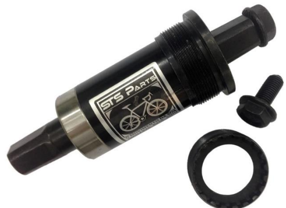
Selado 34,7mm c/Rolamentos Marca: STS Parts ISO 9001 Tamanhos: 113mm, 118mm, 122mm e 127mm
